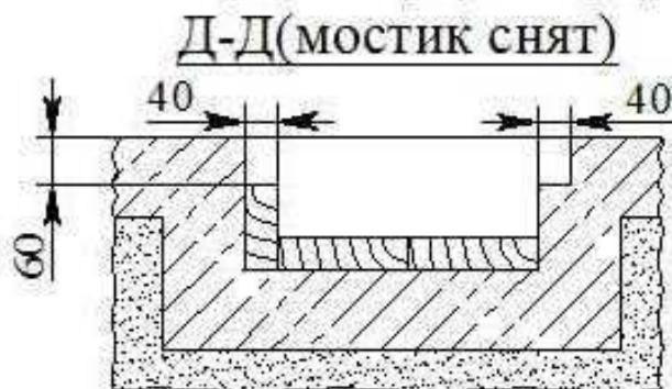
Рис. 15 Съёмные переходные мостики и элементы навозного канала 1 - настил 40x400x550; 2 - брусок 40x60x400; 3 - гвозди 3x80;
