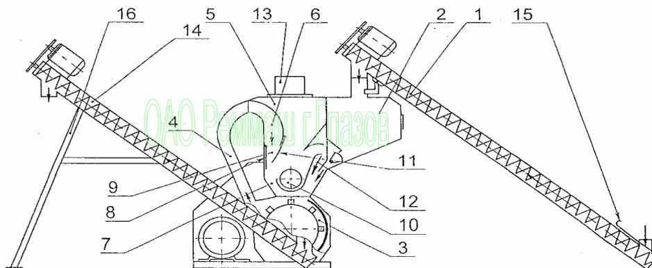
1- шнек загрузочный; 2 – бункер; 3 – камера дробильная; 4 – кормопровод; 5 – накопительная камера; 6 – дефлектор; 7 - возвратный канал; 8 – заслонка; 9 – окно прохода готового продукта; 10 – шнек дробилки; 11 – козырек; 12 – рециркулирующий канал воздуха; 13 – фильтр; 14 – шнек выгрузной; 15 – заслонка загрузочного шнека; 16 – стойка.
